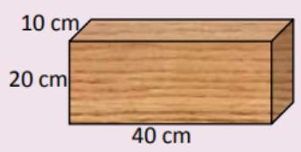
يبين الشكل قطعة خشب وزنها  $(50) \text{ N}$ ، وأبعادها  $40 \text{ cm} \times 20 \text{ cm} \times 10 \text{ cm}$ . أحسب أكبر وأقل ضغط يمكن أن تحدثه هذه القطعة عند وضعها على سطح طاولة أفقي.
